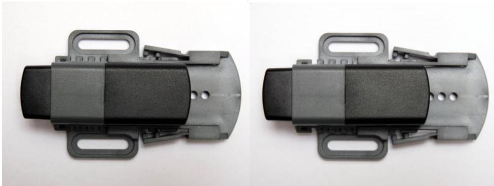
Для контроля положения двери электрических шкафов мы предлагаем концевой выключатель в трех различных версиях исполнения. Например, он может быть использован для включения света при открытии двери (NC) или для включения вентилятора с фильтром при закрытии двери (NO). Вариант с переключающим контактом (CO) может использоваться как с нормально замкнутым и / или нормально разомкнутым контактом.
