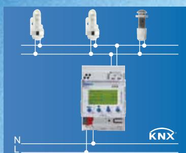
До трех датчиков освещенности могут быть подключены к прибору.
