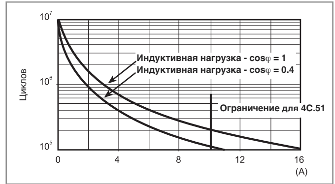
F 4С - Электрическая долговечность (АС) при ном. нагрузке, Типы 4С.01/51
